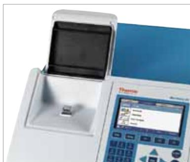
Multiskan GO accepts versatile cuvettes
