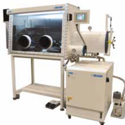
UNILab Pro - Handskbox system för eliminering av O 2 och fukt. (Modellen på bilden har som tillval inbyggd frys)
